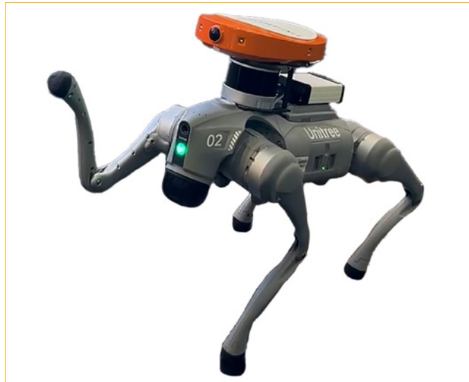
Abb. 02: Forschungsprojekt Roboterhund mit Helmcamerasystem [Quelle: Open Experience GmbH]
