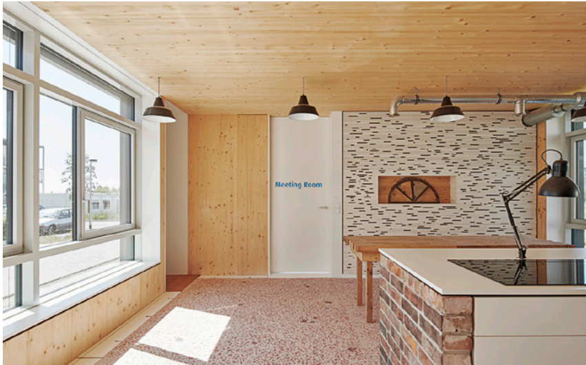
Abb. 07: Terrazzo »Opus Signium« aus Nebenprodukten der Dachziegelherstellung [Foto: © Olaf Mahlstedt]
